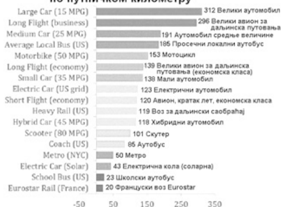
Слика 3. Карбонски отисак различитих врста возила за превоз путника (састављен према подацима DEFRA – Department for Environment, Food and Rural Affairs [8]) [4]
