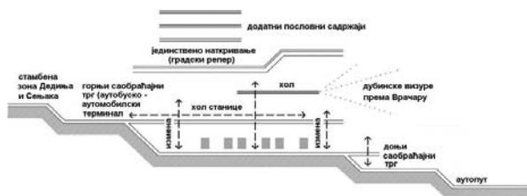
Слика 10. Попречни профил комплекса нове железничке станице Београд Центар са претпостављеном диспозицијом основних намена и потенцијалом средишта мулти-модалног саобраћаја [18]
