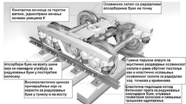
Слика 13. Мере у конструкцији возила и колосека за смањење буке у додиру точка и шине [13]
