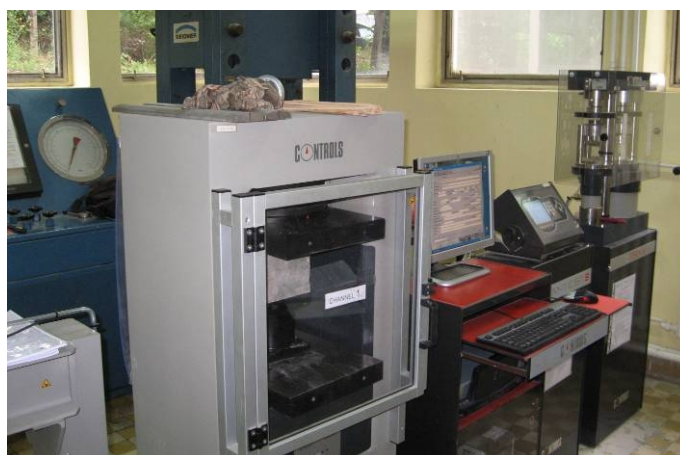
Slika 26. Univerzalna presa i sistem za akviziciju podataka (Institut za puteve)
