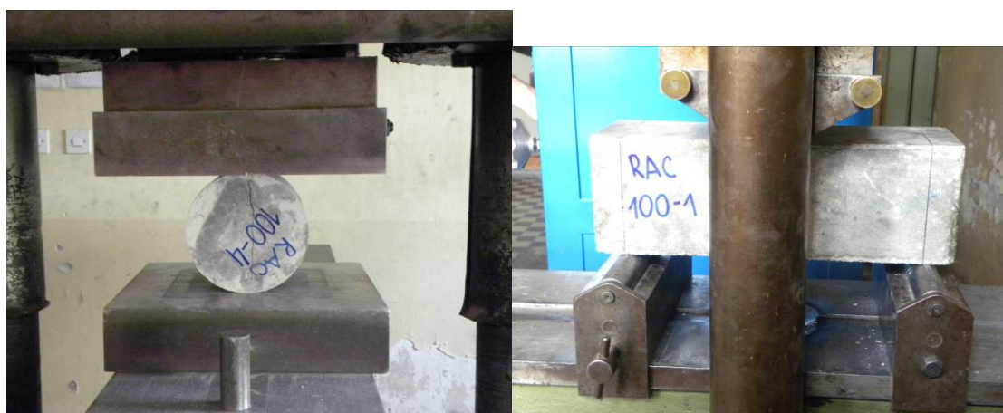
Slika 77. Ispitivanje čvrstoće pri zatezanju cepanjem (levo) i savijanjem (desno)
