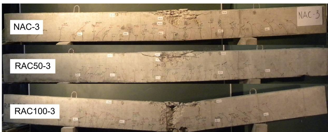
Slika 45. Lom greda sa „maksimalnim“ procentom armiranja
