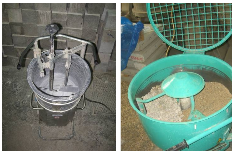
Slika 22. Mešalice za probna ispitivanja 1. faze (levo) i 2. faze (desno)
