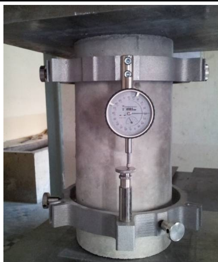
Slika 29. Ispitivanje modula elastičnosti u laboratoriji IMK
