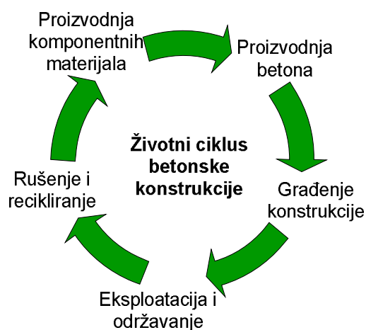
Slika 1. Životni ciklus betonske konstrukcije
