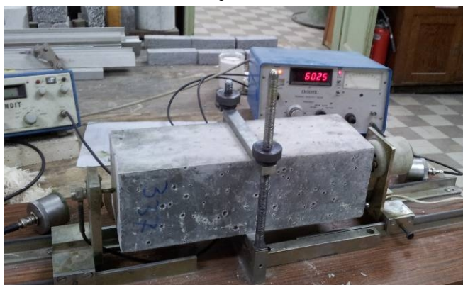
Slika 72. Ispitivanje dinamičkog modula elastičnosti metodom rezonantne frekvencije
