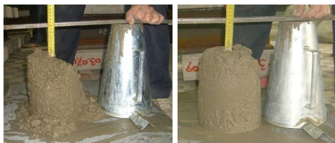
Slika 23. Merenje sleganja odmah nakon spravljanja betona sa recikliranim agregatom i istog betona nakon 30 minuta (desno)
