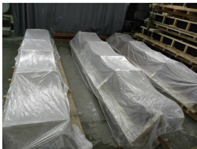
Slika 34. Nega greda odmah nakon betoniranja
