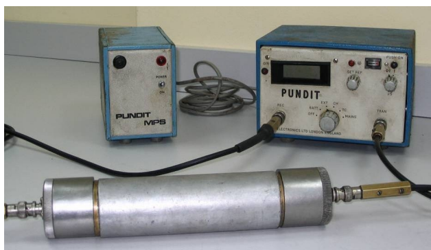
Slika 74. Uređaj za merenje brzine ultrazvučnih talasa
