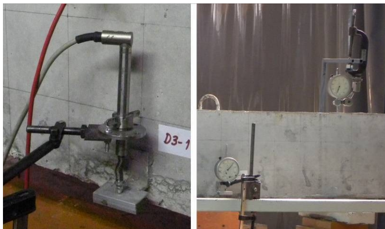
Slika 40. Ugibomeri- induktivni (levo) i mehanički (desno)
