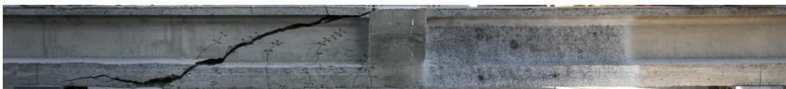
Slika P .6-9: 350-185/80-2: Prikaz prslina nakon loma grede: na južnom (a) i na severnom licu grede (b)
