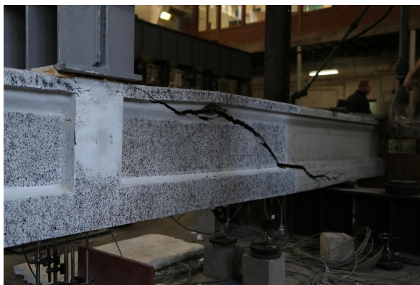
Slika P .7-11: 350D-185/80: Prikaz prsline na severnom licu grede nakon loma
