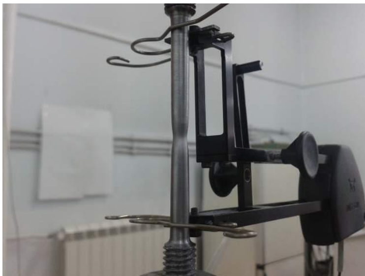
Slika 3.19 Detalj ispitivanja epruvete od armaturne šipke
