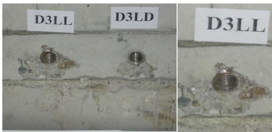
Slika 3.44 Uzorak D3 – detalj oljuskavnja betona ispod smičućeg konektora
