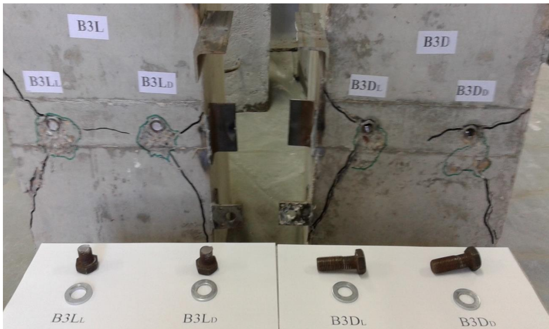
Slika 3.34 Uzorak B3 posle ispitivanja do loma
