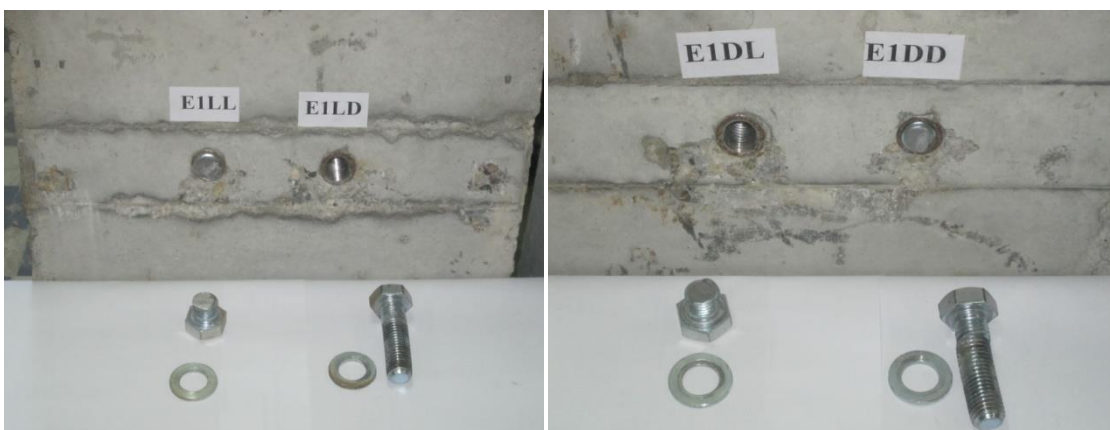
Slika 3.46 Uzorak E1 posle ispitivanja do loma
