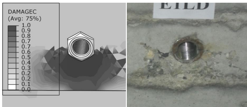
Slika 4.27 Dijagram parametra oštećenja betona pri pritisku – FEM_E (levo) i oštećenje nastalo na uzorku serije E (desno)
