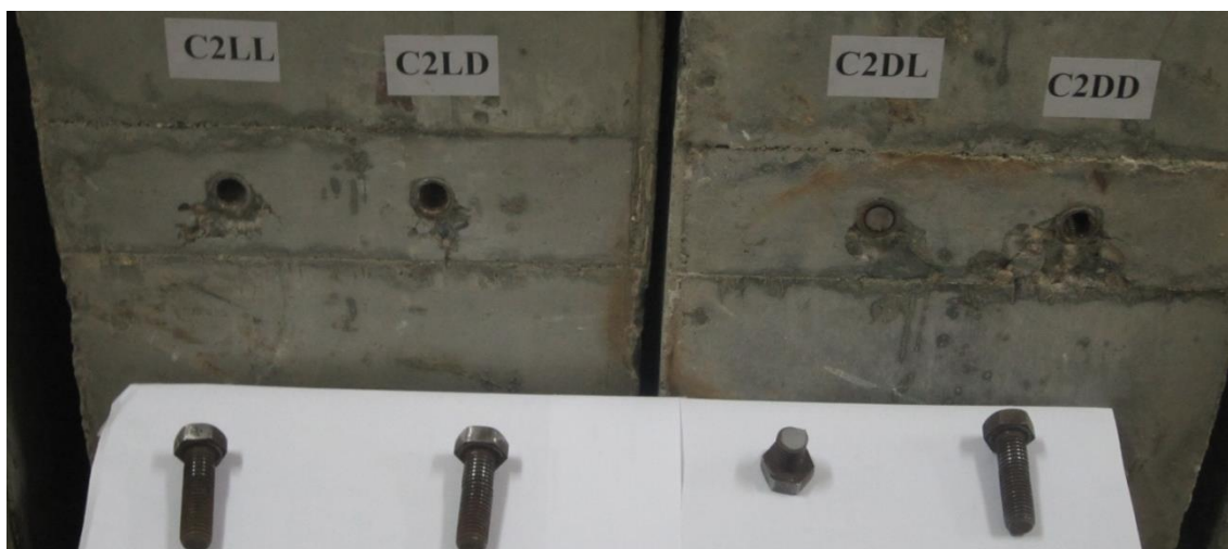
Slika 3.40 Uzorak C2 posle ispitivanja do loma
