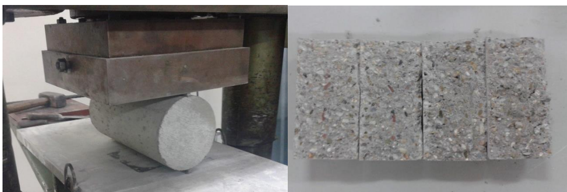
Slika 3.10 Ispitivanje čvrstoće betona pri zatezanju
