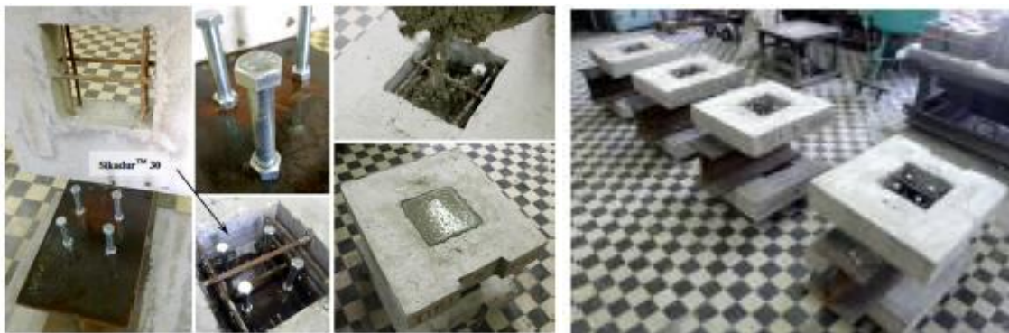
Slika 2.11 Priprema uzoraka sa smičućom vezom zavrtnjima [Pavlović, 2014]
