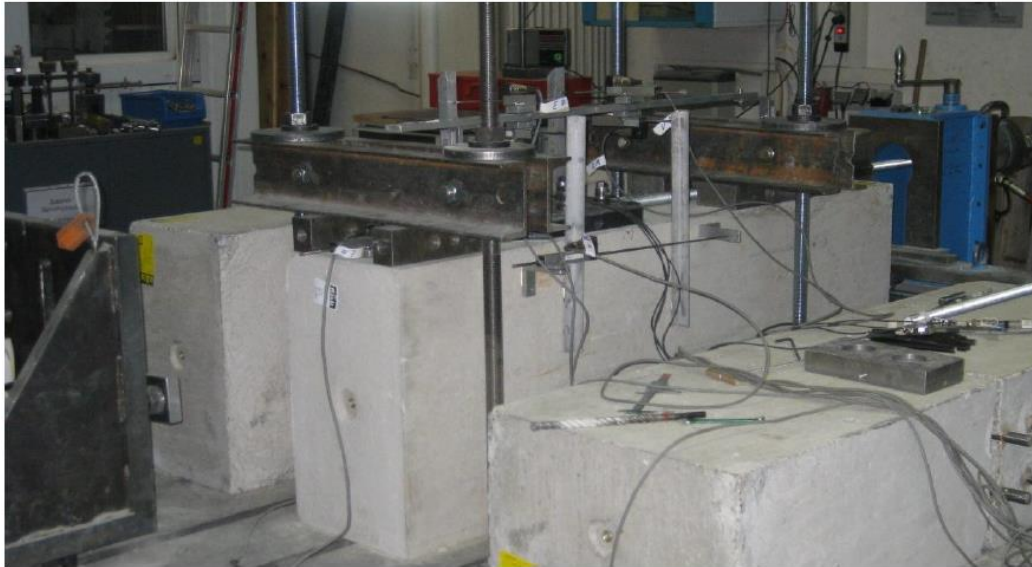
Slika 2.18 Dispozicija ispitivanja ankera u elementima male širine [Grosser, 2012]
