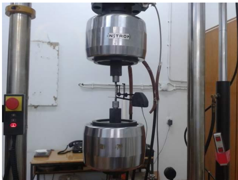
Slika 3.11 Dispozicija ispitivanja čeličnih epruveta na zatezanje Na slici 3.12 prikazane su epruvete is serije 1 i 3 posle ispitivanja.
