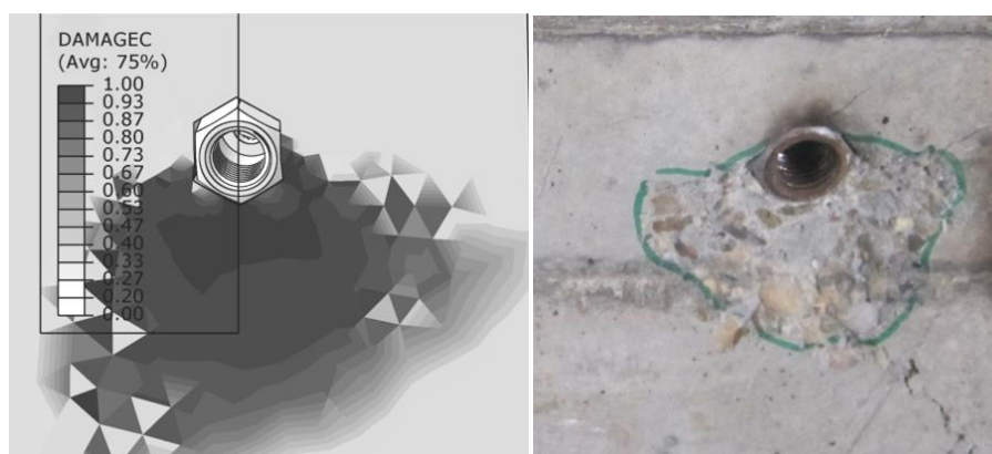
Slika 4.24 Dijagram parametra oštećenja betona pri pritisku – FEM_A (levo) i oštećenje nastalo na uzorku serije A (desno)
