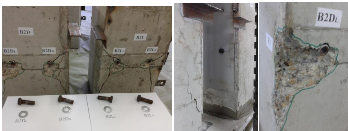
Slika 3.35 Detalji loma uzorka B2 usled blizine ivice betona
