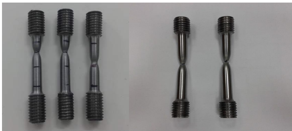
Slika 3.12 Epruvete iz zavrtnjeva M16 i M20 posle ispitivanja
