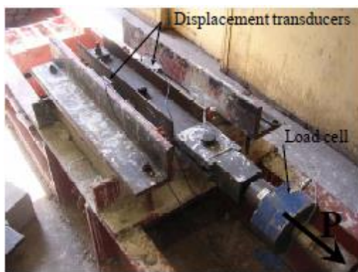
Slika 2.10 Jednostrani smičići test [Kwon, 2008]
