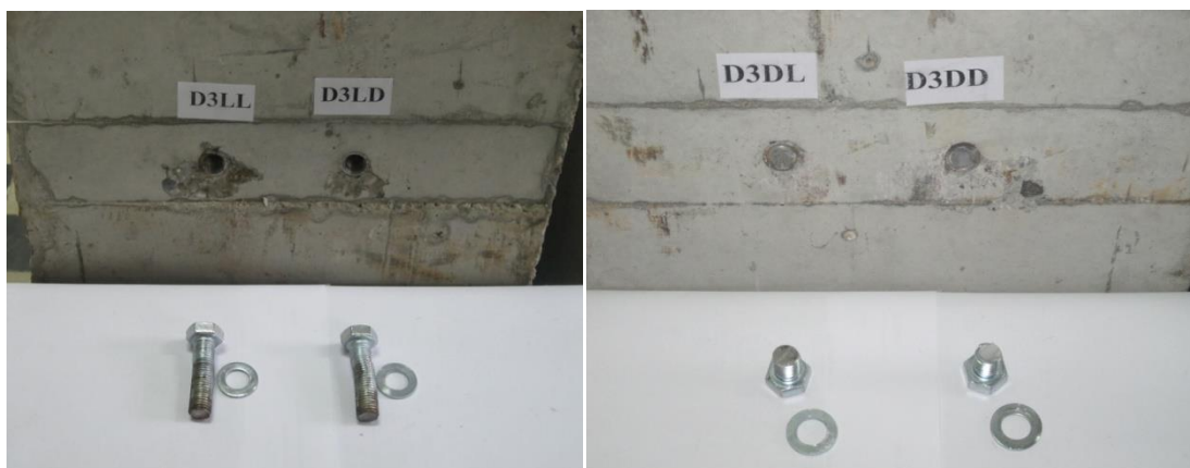
Slika 3.43 Uzorak D3 posle ispitivanja do loma
