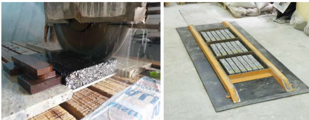
Slika 3.18 Sečenje gredica iz asfaltnih ploča
