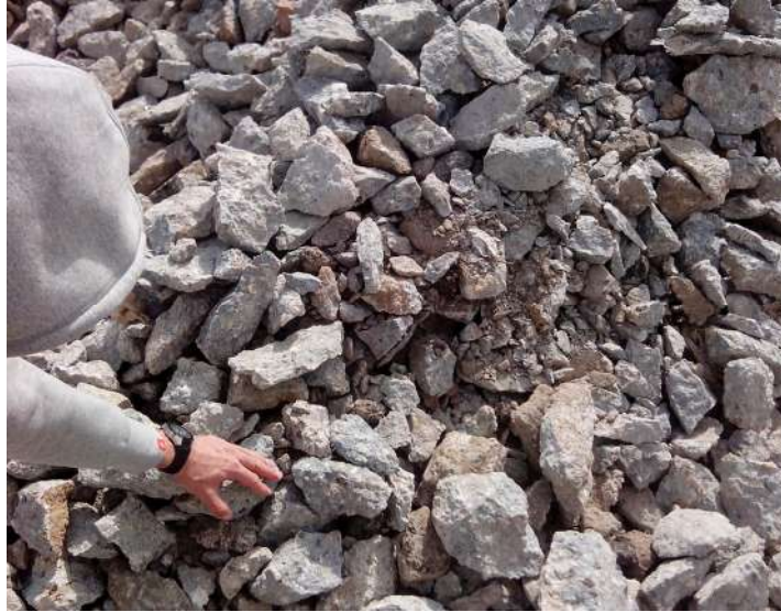
Slika 3.4 Agregat od recikliranog betona krupnoće 0/100 mm
