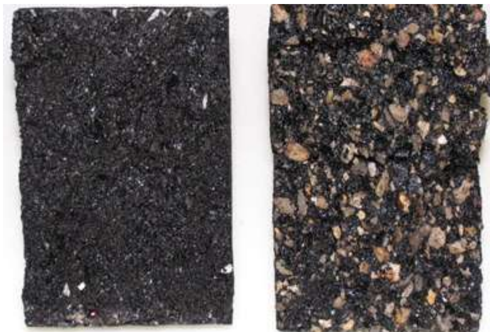
Slika 2.11 Asfaltni uzorak bez oštećenja (levo) i sa oštećenjem usled dejstva vode (desno)
