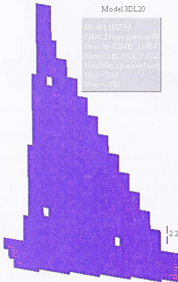
6.29. Средња раван ламеле: зоне напона \sigma_z већег од 2.2 Мпа, на дан 11. 1. 1999.
