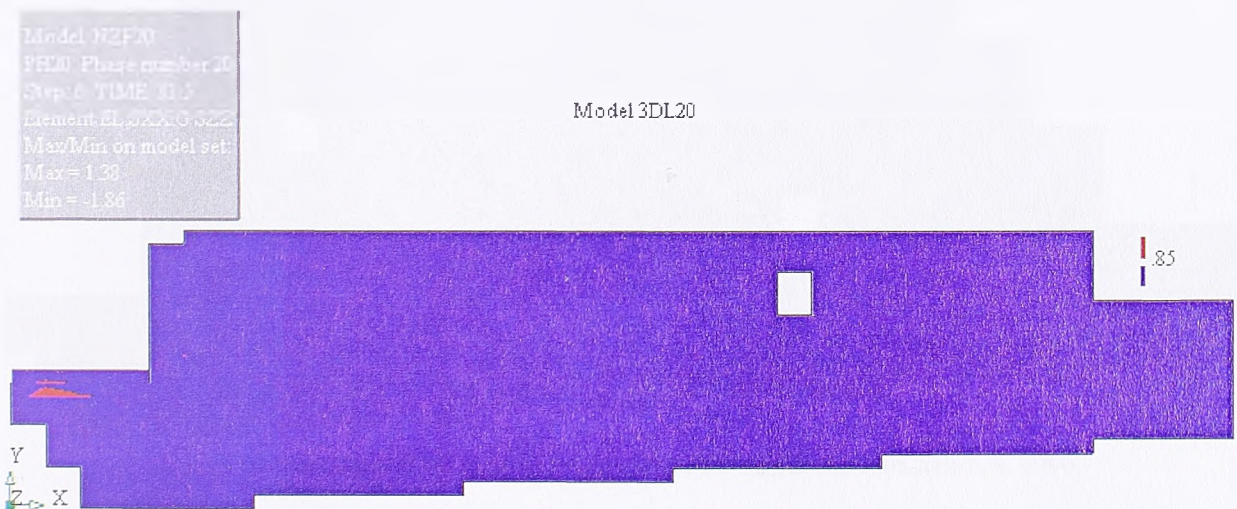
6.13. Средња равна ламеле: зоне напона \sigma_z већег од 0,85 Мпа, на дан 9. 1. 1996.
