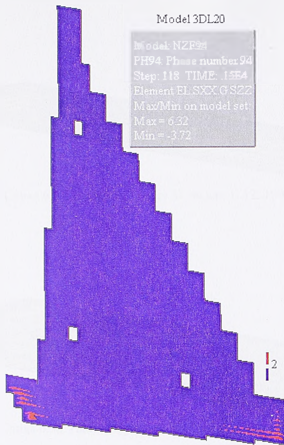
Слика 6.33. Средња раван ламеле: зоне напона \sigma_x већег од 2,0 Мра, на дан 1. 12. 1999.
