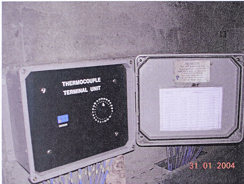
Слика 3.14. Мерна станица за мерење температуре у горњој галерији
