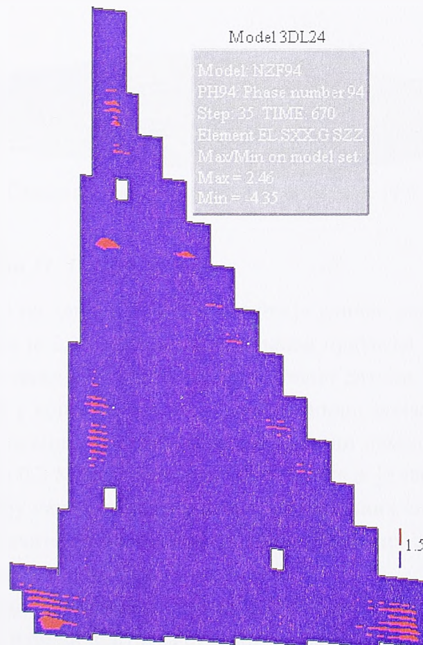
Слика 6.71. Средња раван ламеле: зоне напона \sigma_z већег од 1,5 Мра, на дан 1. 9. 1997.
