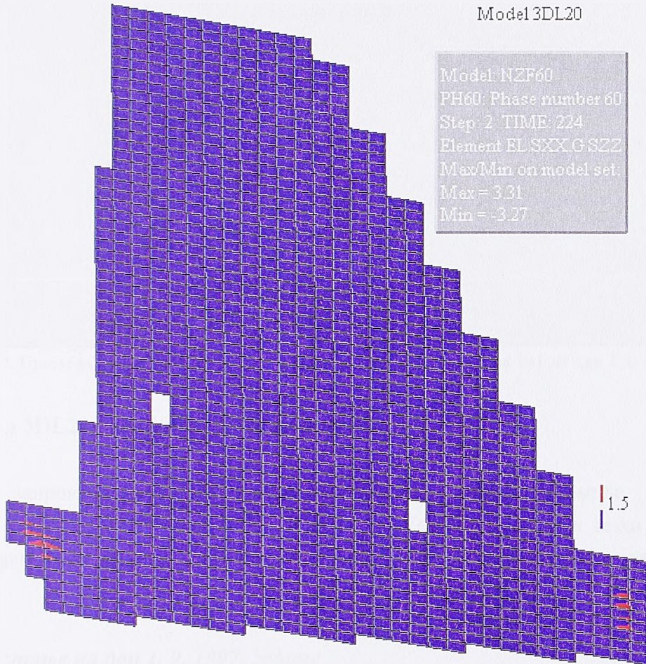
6.20. Средња раван ламеле: зоне напона \sigma_z већег од 1,5 МПа, на дан 1. 6. 1996.
