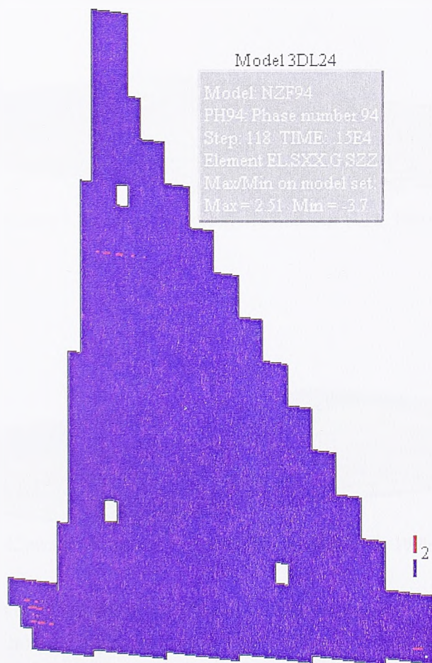
Слика 6.81. Средња раван ламеле: зоне напона \sigma_z већег од 2,0 Мра, на дан 1. 12. 1999.
