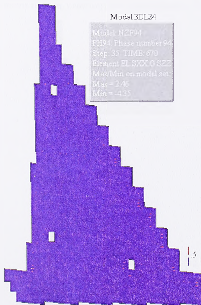
Слика 6.69. Десна граница ламеле: зоне напона затезања већег од 0,5 МПа, на дан 1. 9. 1997.
