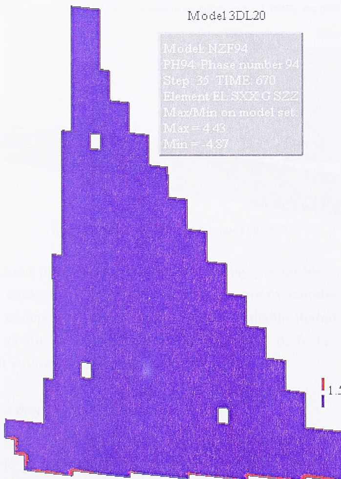
6.24. Десна граница ламеле: Зоне напона затезања већег од 1,5 МПа, на дан 1. 9. 1997.
