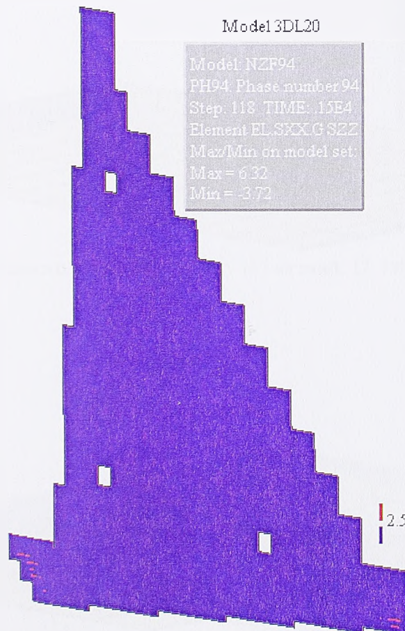
Слика 6.34. Средња раван ламеле: зоне напона \sigma_z већег од 2,5 Мра, на дан 1. 12. 1999.
