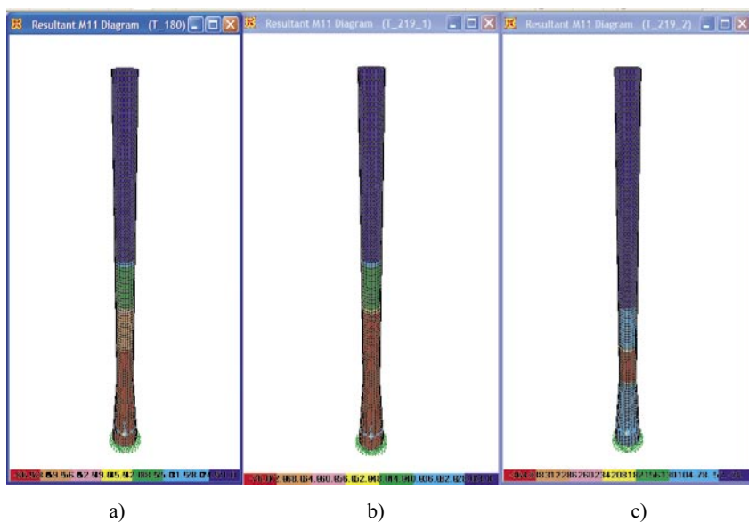
Slika 13. Radijalni momenti savijanja po visini dimnjaka pri stanjima a) T-180, b) T-219-1 i c) T-219-2
