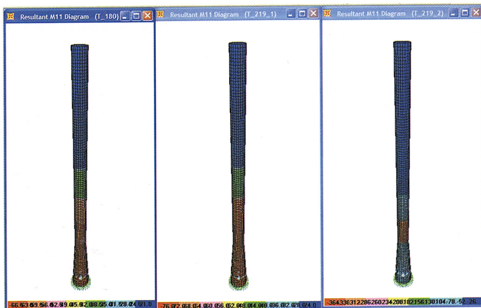
Slika 13. Radijalni momenti savijanja po visini dimnjaka pri stanjima a) T 180, b) T 219 1 i c) T 219 2
