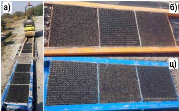
Слика 1. (а) уградња плоча глатким ваљком од једне тоне, (б, ц) уграђени доњи слојеви плоча без и са геомрежом
