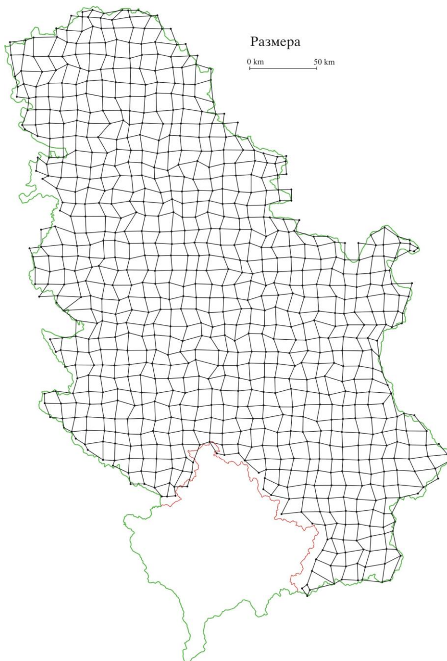
Слика 5.7. Подела подручја трансформације на коначне елементе
