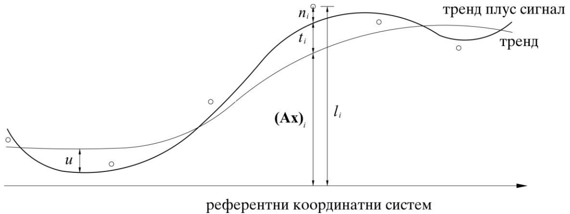
Слика 4.4. Графичка интерпретација процеса колокације по методи најмањих квадрата
