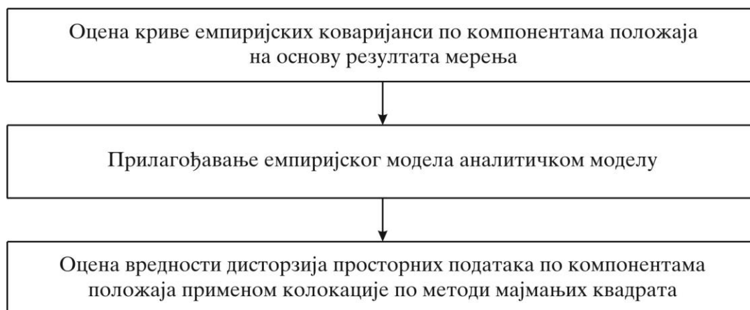
Слика 5.10. Блокдијаграм поступка оцене вредности дисторзија просторних података применом колокације по методи најмањих квадрата
