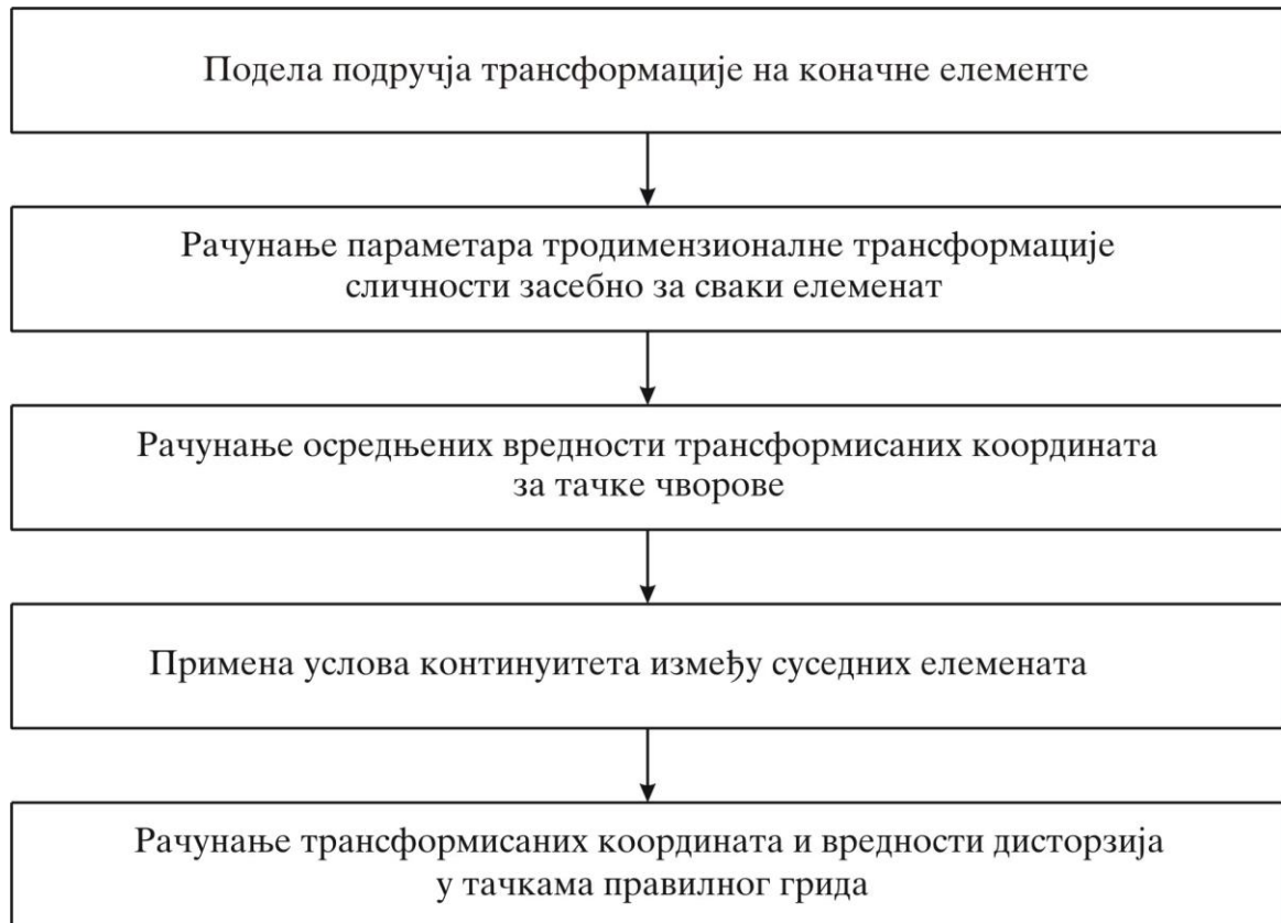
Слика 5.5. Блокдијаграм процеса оцене вредности дисторзија просторних података у тачкама правилног грида поделом подручја трансформације на коначне елементе
