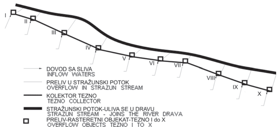
Slika 2. Deo kolektora Tezno I sa dovodima sa podslivova do preliva i ispustima u Stražunski kanal
