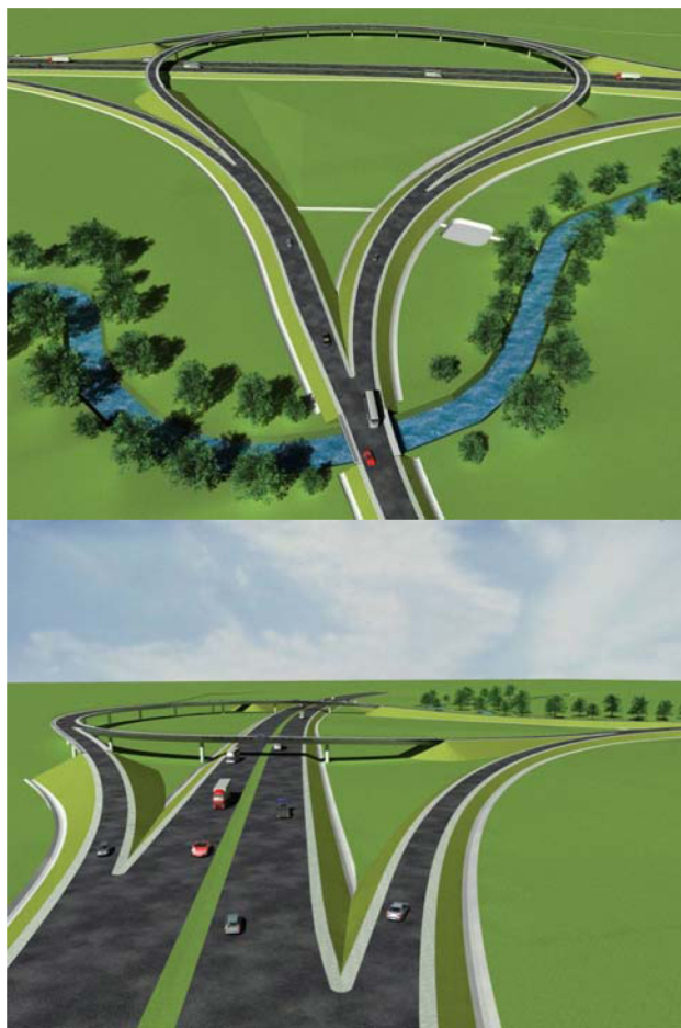
Slika 3: Perspektivni prikazi denivelisane raskrsnice tipa "KRUŠKA" [8]
