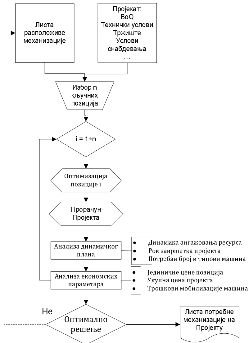
Слика 5.3 - Алгоритам оптимизације избора машина на нивоу Пројекта
