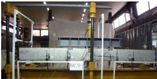
Слика 6. Диспозиција испитивања и распоред мерне опреме
