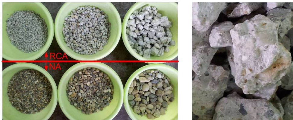
Слика 2. Изглед зрна рециклираног и природног агрегата по фракцијама (лево) и детаљ зрна рециклираног агрегата (десно)
