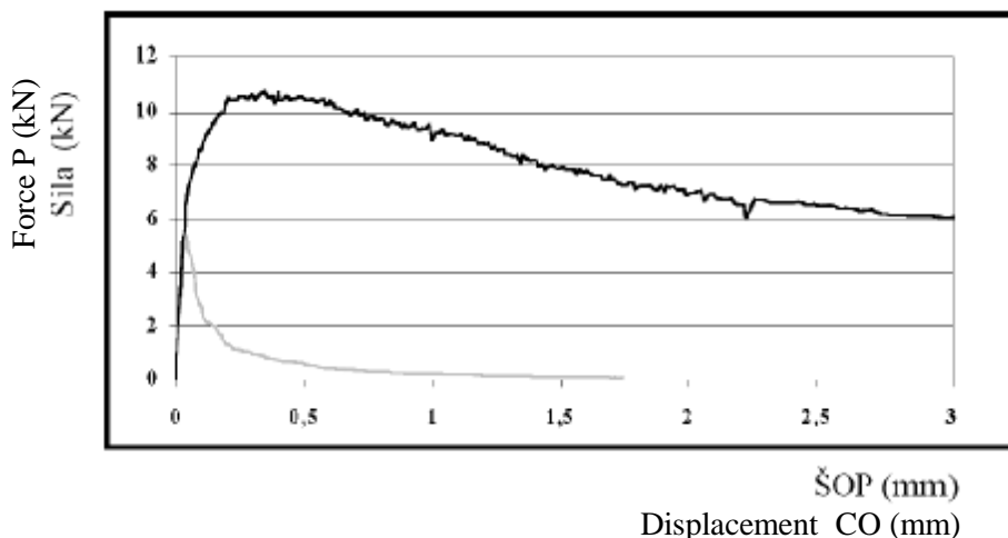
Slika 10. Karakteristični dijagrami P - \dot{S}OP za slučaj betona sa i bez vlakana [16] Figure 10. Characteristic P - CO diagrams for reference (1) and fiber reinforced concrete (2) [16]
