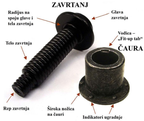
Slika 3. Spojno sredstvo sistema „Huck BobTail“
