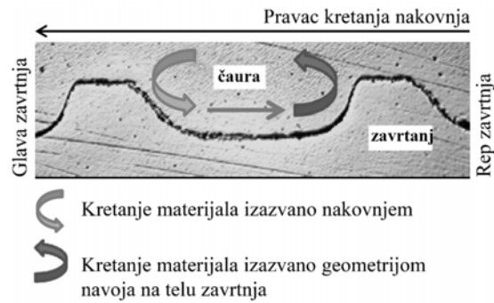
Slika 10. Princip unošenja sile prednaprezanja u HBT zavrtnaj
