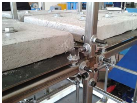
Slika 6 – Detalj veze u jednom od čvorova konstrukcije
