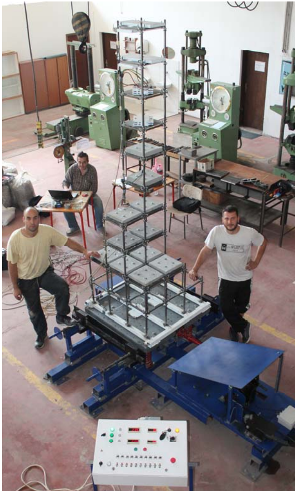
Slika 9 – Model konstrukcije višespratne zgrade na vibro-plaformi
