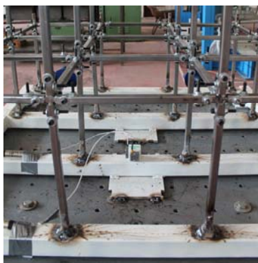
Slika 8 – Veza konstrukcije za vibro-platfomu (kruta veza - uklještenje)
