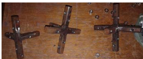
Slika 7 – Elementi za vezu stubova i greda pomoću kojih je ostvarena kruta veza
