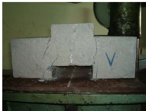
Slika 7. Dispozicija uzoraka za ispitivanje na smicanje
