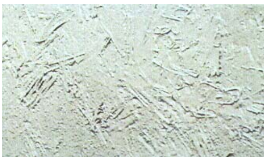
Slika 2. Izgled pojedinačnih a) monofilamentnih i b) fibrilizovanih vlakana
