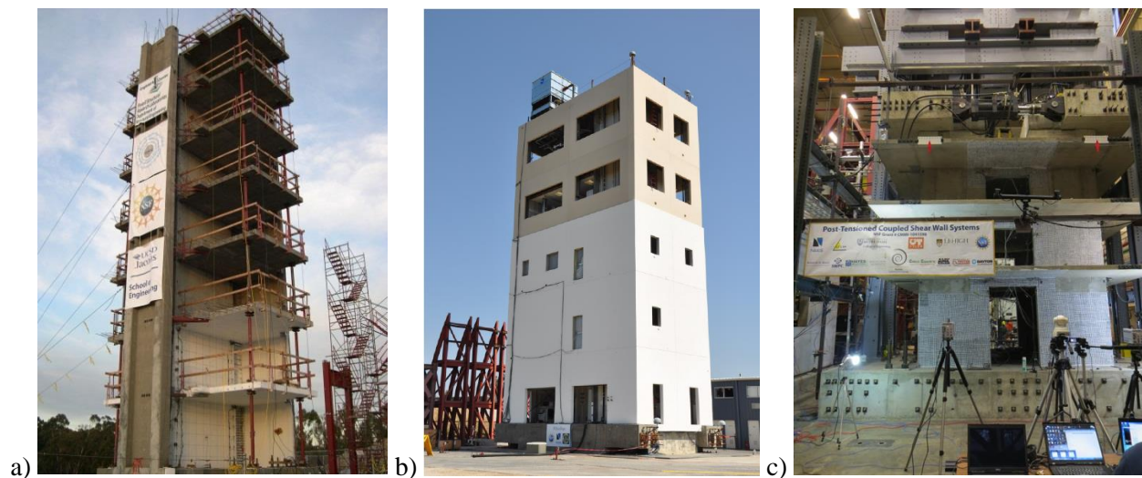
Slika: 3.3 a, b) Ispitivanja zidova u okviru sedmospratnog i petospratnog uzorka zgrade u punoj veličini, Jacobs School of Engineering na Kalifornijskom Univerzitetu u San Diegu (2006. i 2012. godina); c) ispitivanje povezanih zidova u trospratnm uzorku na NEES institutu (2013. godina)
