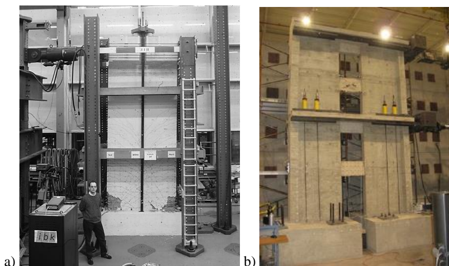
Slika: 3.4 a) Ispitivanje šest uzoraka AB zidova ETH, slika: (Dazio i dr., 1999), b) uzorak udvojenih zidova i veznih greda od HPFRC, slika: (Lequesne et al., 2009)
