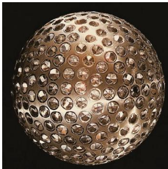
Слика 5.5. LAGEOS сателит са пречником сфере 60 cm и 426 ретро-рефлектора ( http://ilrs.gsfc.nasa.gov ).
