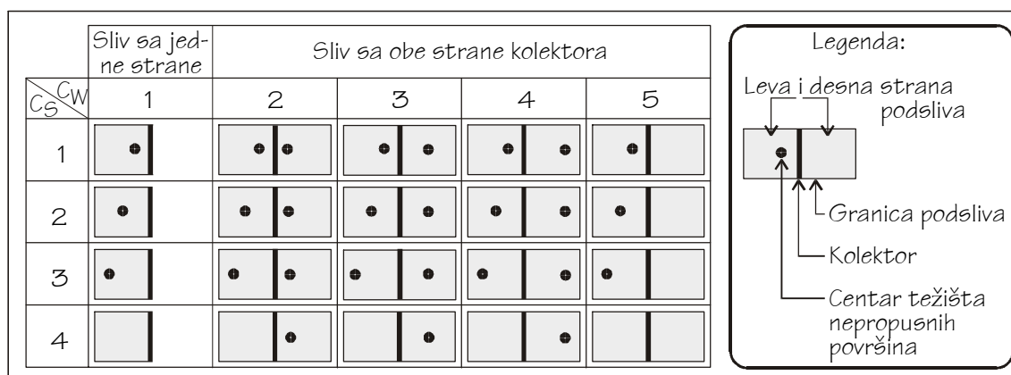
Slika 6.4: Parametri podslivova C_W i C_S za Hystem-Extran model [30]
