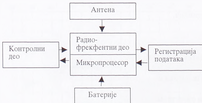
Слика 2.2.3-1: Основне компоненте ГПС пријемника
