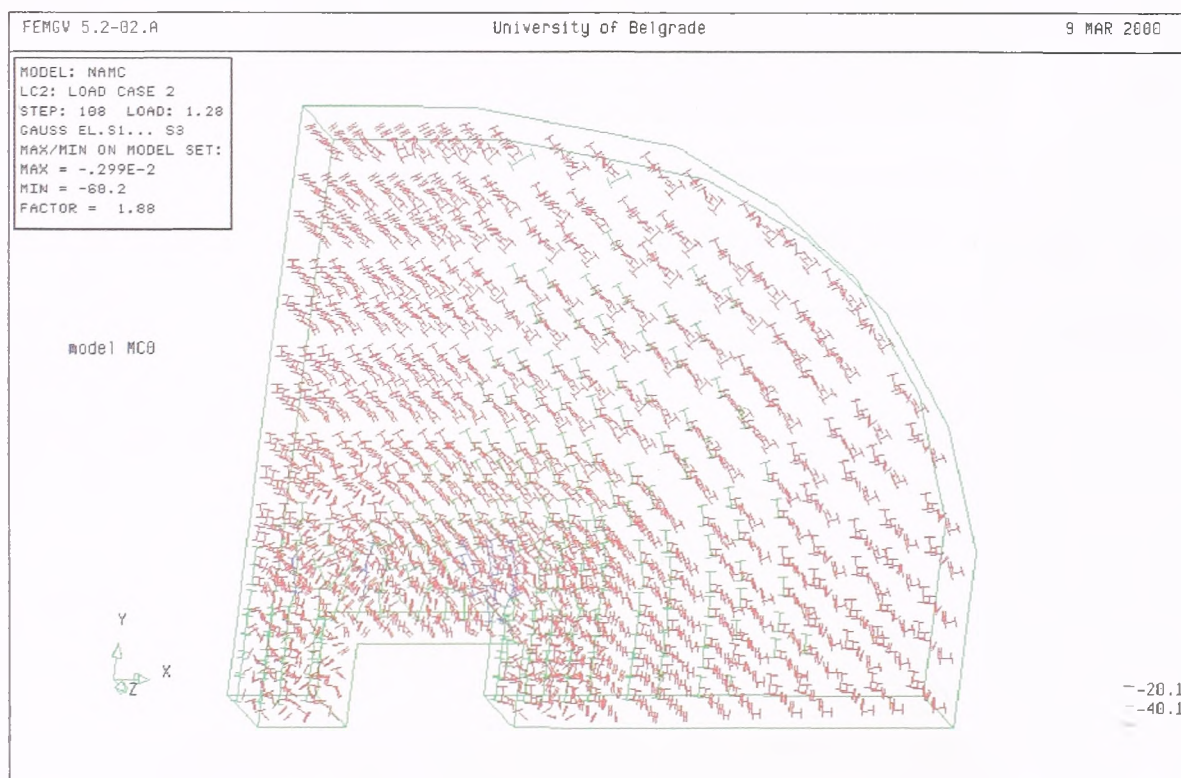
Slika 5.35 Glavni naponi pritiska S_3 u trenutku računskog loma - 434 kN
