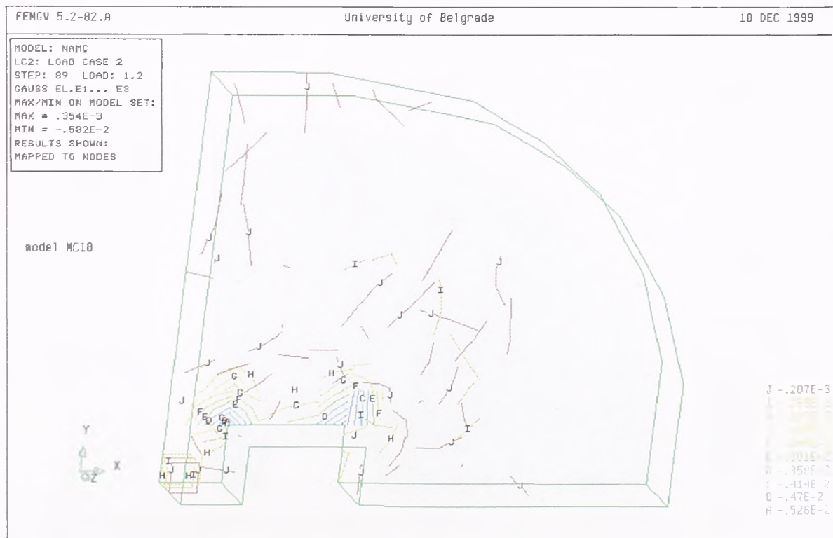
Slika 5.44 Glavne dilatacije pritiska \epsilon_3 u trenutku računskog loma - sila 444 kN
