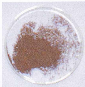
Slika 5-1. Materijali-sorbenti za analizu sorpcije arsena u šaržnom sistemu.
