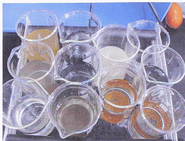
Slika 5-2. Ispitivanje mehanizama sorpcije u šaržnom sistemu
