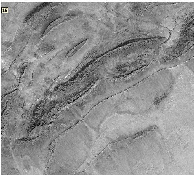
Сл. 5. Снимак Ландсат 7 сателита, канал 7, после извршеног побољшања контраста, коришћењем линеарне методе
