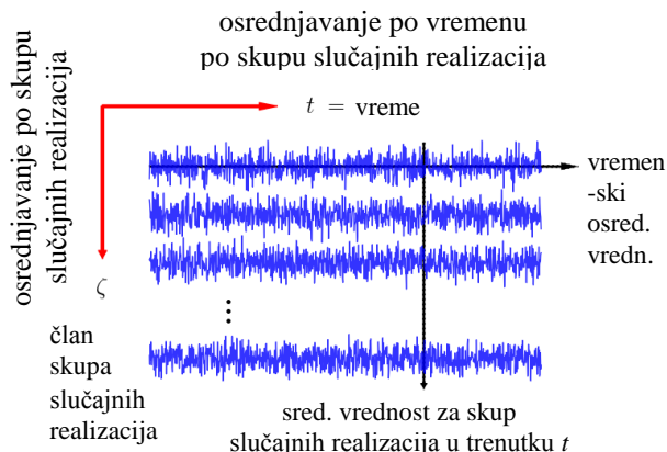
Slika 6. Osrednjavanje po vremenu i osrednjavanje po skupu slučajnih realizacija [27]. Osrednjavanje po vremenu može se obaviti za svaku realizaciju (ogled ili terensko merenje). Osrednjavanje po skupu slučajnih realizacija sprovodi se u jednom trenutku za sve realizacije iz datog skupa.
