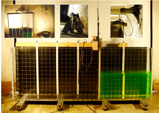
Slika 5. Instalacija na kojoj se ispituje problem rušenja brane i udara vode u zid rezervoara [10]
