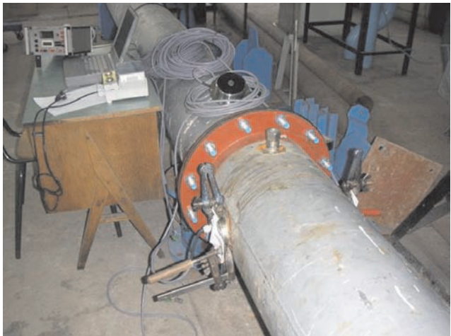
Slika 2. EM sonda za brzine predviđena za ugradnju u potisne cevovode i njihova kalibracija na \text{Fl}350 mm cevi u Laboratoriji
