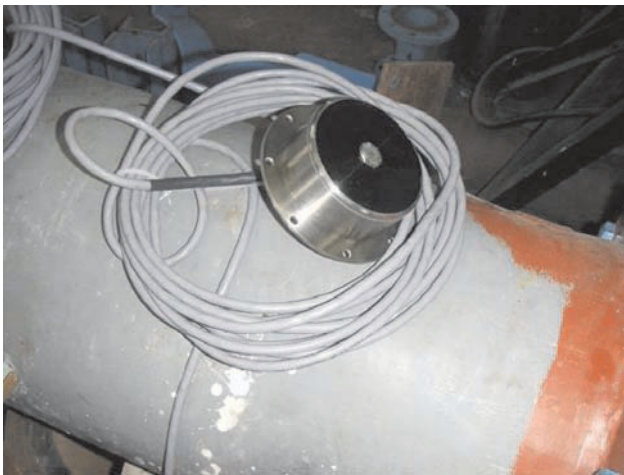
Slika 2. EM sonda za brzine predviđena za ugradnju u potisne cevovode i njihova kalibracija na \text{Fl}350 mm cevi u Laboratoriji
