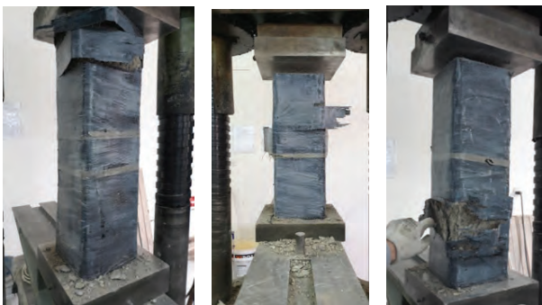
Slika 5. Lom elemenata ojačanih trakom po celoj visini sa oborenim ivicama [2]
