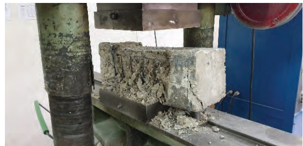
Slika 6. Uklanjanje karbonskih tkanina sa elemenata
