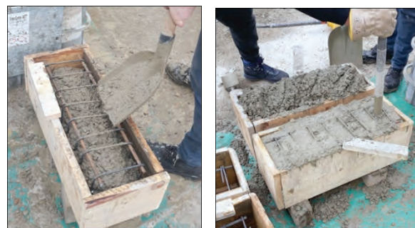
Slika 3. Prikaz faza ugrađivanja betona u oplatu dimenzija 20x20x60 cm [2]
