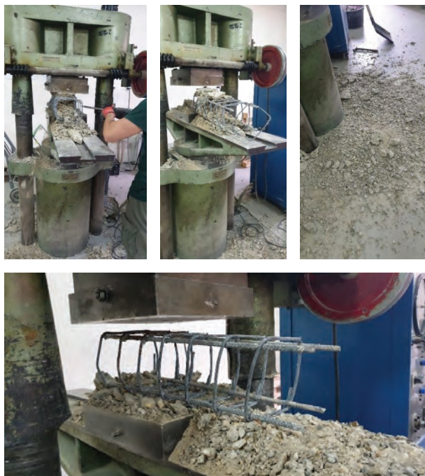
Slika 8. Razdvajanje na komponentne materijale
