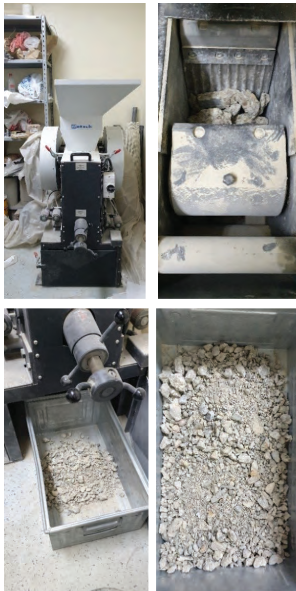
Slika 9. Drobljenje betona u drobilici
