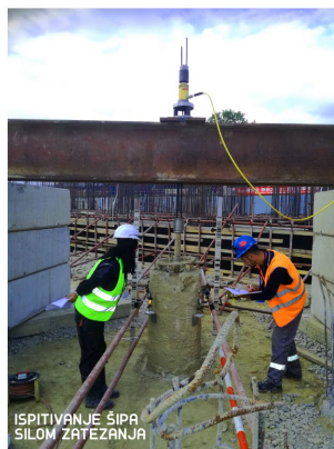
ŠEST HIDRAULIČKIH PARNJ PRESA KAPACITETA 15000 KN I MERNJA OPREMA TOKOM ISPITIVANJA
