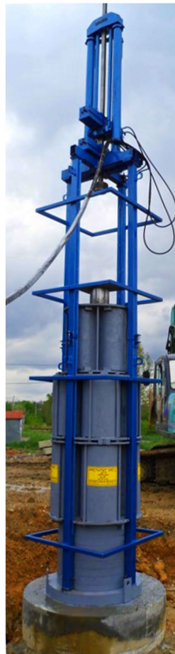
ŠEST HIDRAULIČKIH PARNJ PRESA KAPACITETA 15000 KN I MERNJA OPREMA TOKOM ISPITIVANJA
