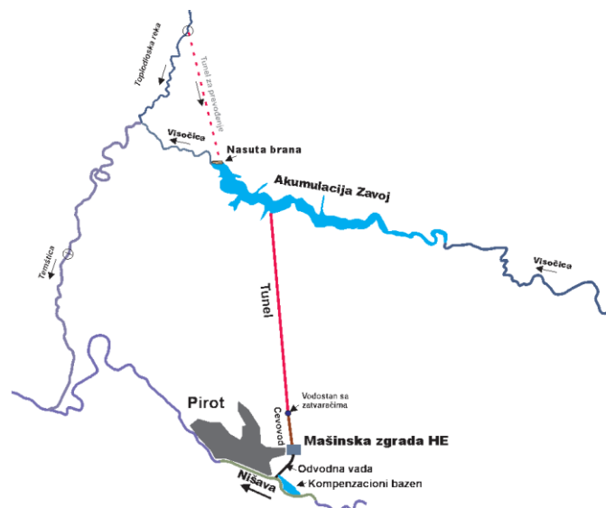
Slika 2. Dispozicija vodoprivrednog sistema Pirot sa ključnim elementima
