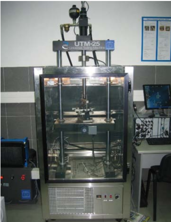
Универзална преса IPC UTM 25 за испитивање асфалтних мешавина
