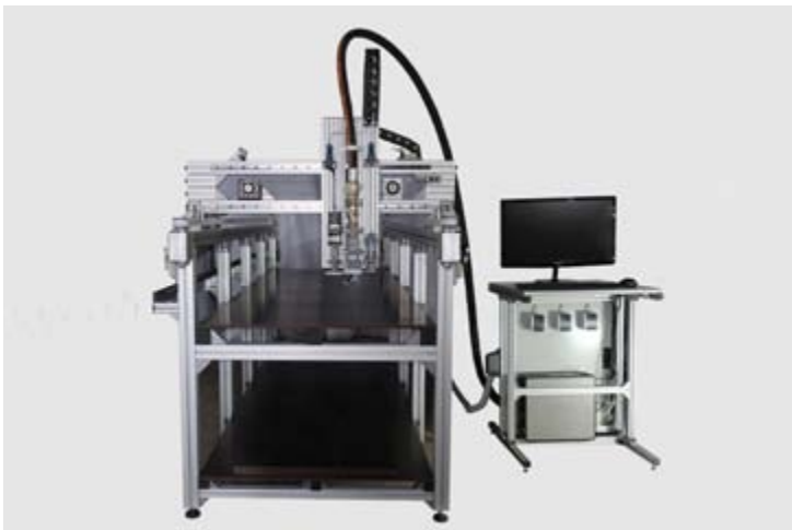
3Д штампач бетонских композита
