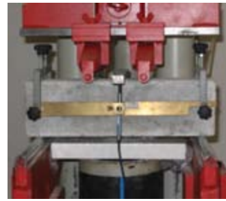
Испитивање дуктилности микроармираног бетона
