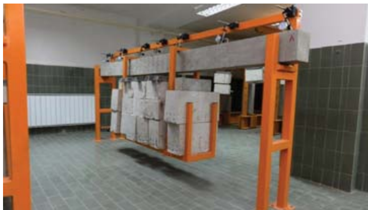
Испитивање утицаја дуготрајног дејства на греде направљене од зелених бетона
