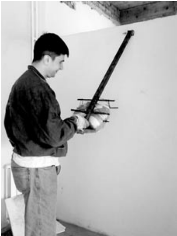
Slika 3. Princip rada uređaja za ispitivanje – puštanje sa određene visine
