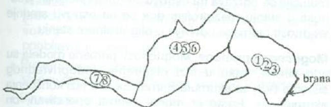
Sl. 7. - Diskretizacija jezera "Barje" za potrebe modeliranja Segmentation of "Barje" reservoir
