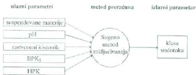
Slika 5. – Šematski prikaz fazi sistema za određivanje klase vodotoka
