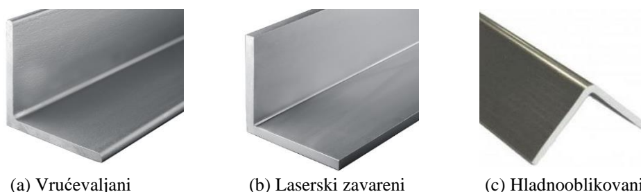
Slika 1 – Ugaonici dobijeni različitim proizvodnim procesima
