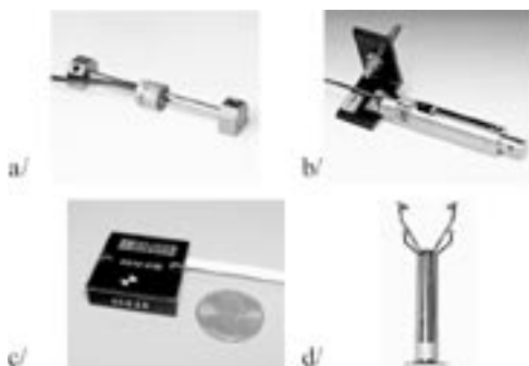
Slika 4. Primljeni senzori sistema a/ Deformetri sa vibrirajućom žicom; b/ Klinometar sa vibrirajućom žicom; c/ MEMS akcelerometar; d/ Ultrazvučni anemometar
