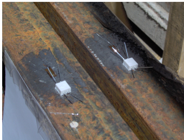
Slika 10.17 – Merno mesto na zatezi
