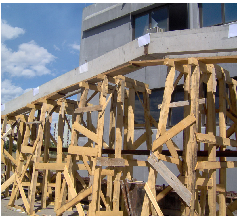
Slika 5.6.1.1. Izgled nosača spremnog za nanošenje opterećenja
