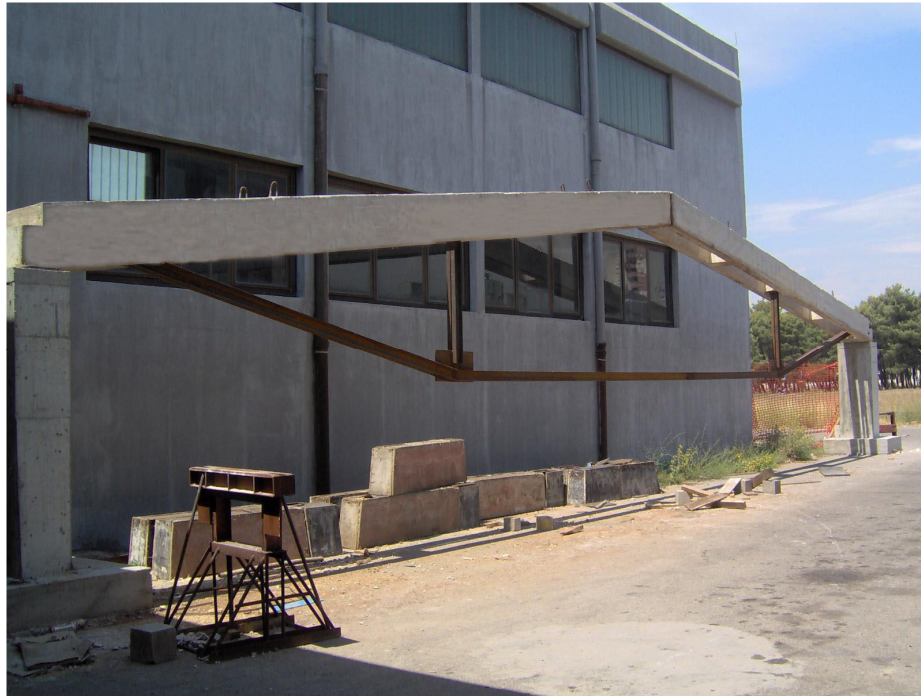
Slika 5.4.7. Izgled nosača na betonskim osloncima pre merenja i nanošenja faza opterećenja
