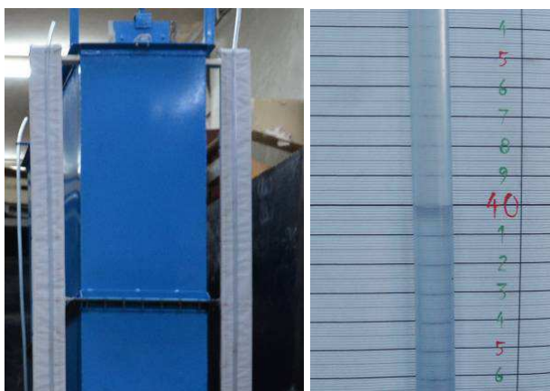
Слика 5.6 - Мерни лењир и пијезометарска цев за мерење дубине воде у резервоару
