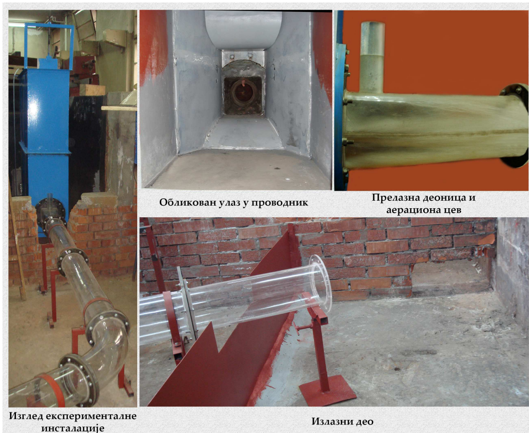
Слика 5.3 - Фотографије експерименталне инсталације
