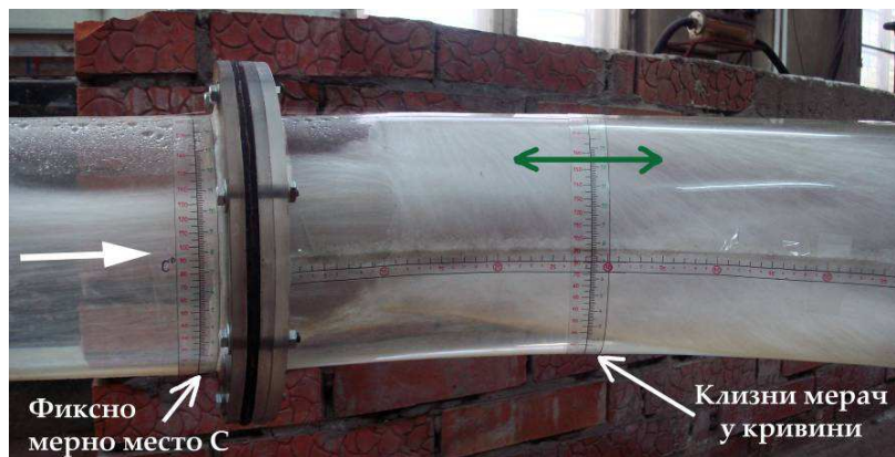
Слика 5.7 - Мерење дубине тока у проводнику
