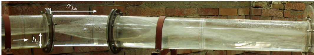
Слика 9.9 – Прелазно течење на моделу D/R = 1/3 и \alpha = 45^\circ (Опит бр. 7)
