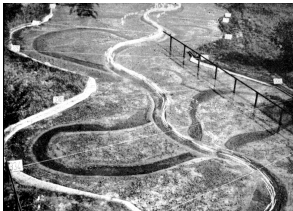
Slika 13.2: Fizički model Velike Morave sa nepokretnim dnom, izgradjen u razmeri 1:40/200 u cilju proučavanja efekata prosecanja krivina [118].
