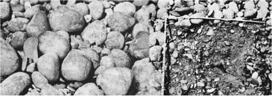
Slika 9.8: Krupni šljunčani materijal u armirajućem sloju i sitniji materijal ispod armirajućeg sloja.
