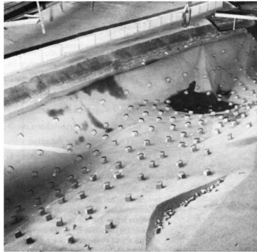
Slika 13.3: Elementi apsolutne rapavosti u koritu rečnog modela [76].
