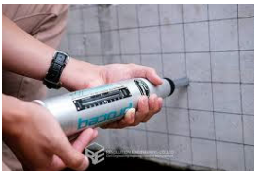
Слика 4. Испитивање помоћу склерометра
