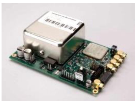
Sl. 8. GPSDO modul, bez prijemnika, proizvođača Acquisys [14].
