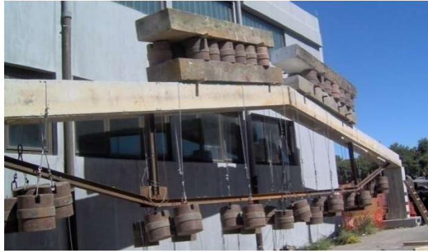
Slika 5 - Opterećenje VI faze na levoj polovini nosača (Furtula, 2015). Figure 5. Loading of VI phase on the left side of the system (Furtula, 2015)
