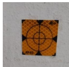
Слика 1 – Самолепљива рефлектујућа маркица
