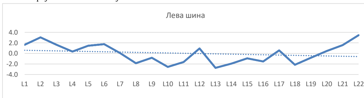
График 1 – Диспозиција тачака леве шине [mm] у односу на регресиону праву шине
