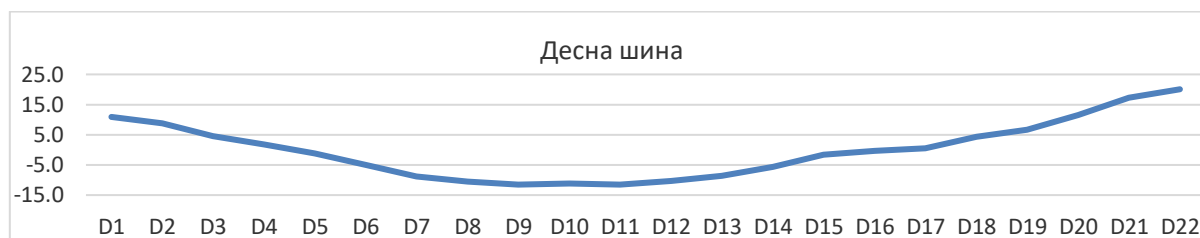
График 4 – Вертикална диспозиција тачака десне шине [mm] у односу на средњу висину десне шине
