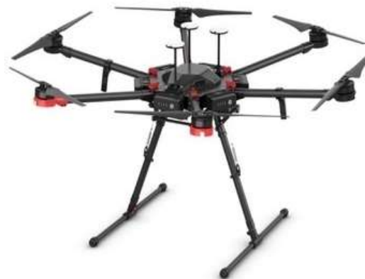
Slika 2 - UAV bespilotna letelica - DJI Matrice 600 Pro [9]
