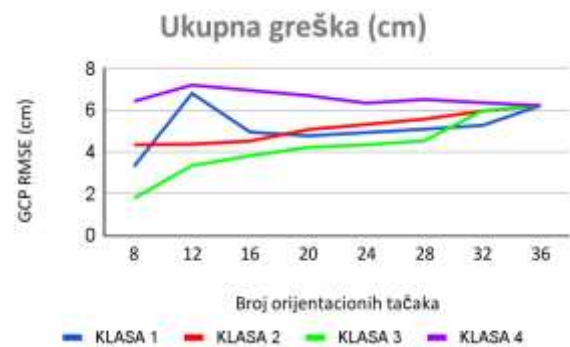
Slika 7 - Ukupni GCP RMSE za četiri klase konfiguracije u odnosu na broj orijentacionih tačaka
