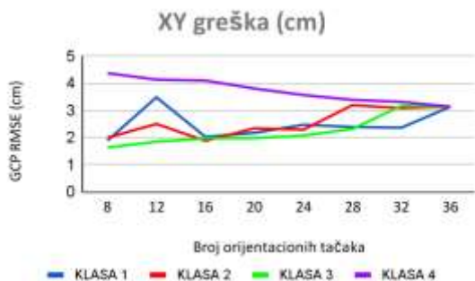
Slika 5 - Ukupni GCP RMSE za četiri klase konfiguracije u odnosu na XY osu i broj orijentacionih tačaka
