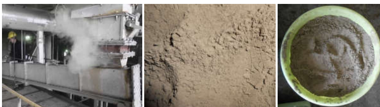
Slika 5. a) Mesto sa kog je sakupljen leteći pepeo u TE Nikola Tesla B u Obrenovcu, b,c) uzorak letećeg pepela
