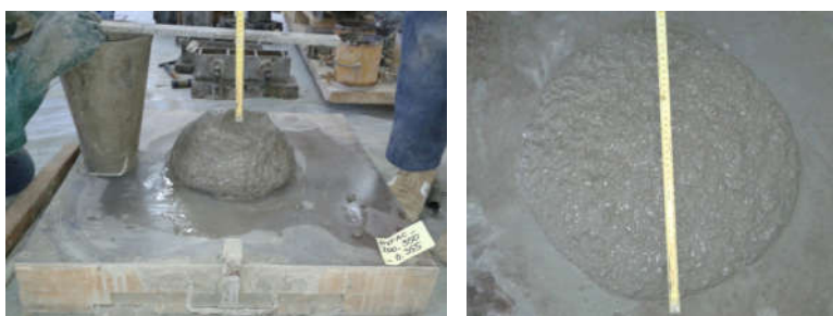
Slika 8. a) Metoda sleganja Abramsovim konusom (levo), b) Metoda rasprostiranjem (desno)
