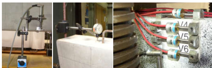
Slika 16. a) Elektronski ugibomer, b) mehanički ugibomer, c) senzori sa vibrirajućom žicom
