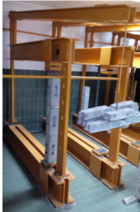
Slika 9. a) Ram sa uzorcima za ispitivanje tečenja (levo), b) temperatura i vlažnost sredine prilikom ispitivanja tečenja i skupljanja (desno)
