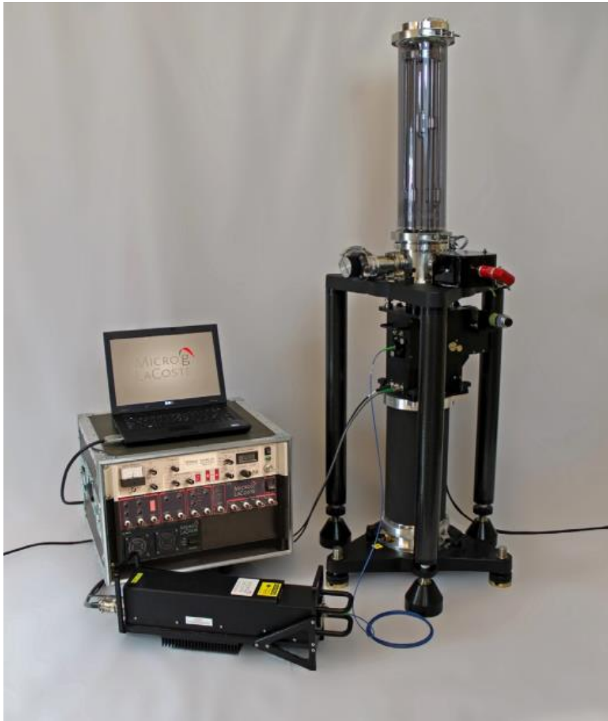
Слика 4.8. Апсолутни гравиметар FG5X, Micro-g LaCoste (Niebauer, 2015)
