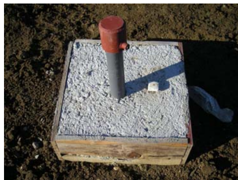
Slika 2 - Reperne tačke na pijezometara. duž obala novog korita Kolubare
