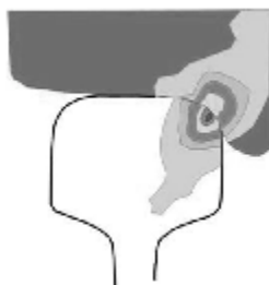
Slika 18. Kritična zona za pojavu defekta tipa head checking [5] Figure 18. Head checking emergence zone [5]
