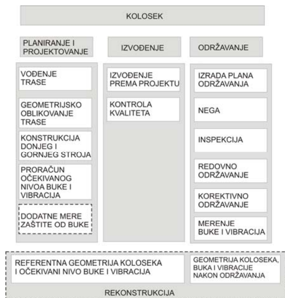
Slika 1 - Praćenje nivoa buke i vibracija tokom eksploatacionog veka koloseka
